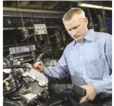
Überprüfung von Ventilen durch die Zündkerzenöffnung.
